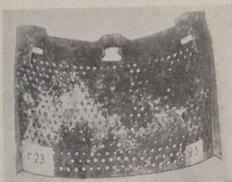
Рис. 5. Колосниковая решетка установки Г-23
