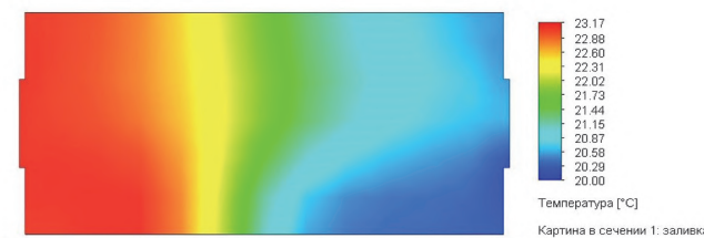
Рисунок 5 – Распространение температуры в помольном барабане
