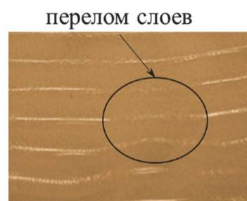
Рисунок 8 – Перелом сжатых слоев при разрушении образца
