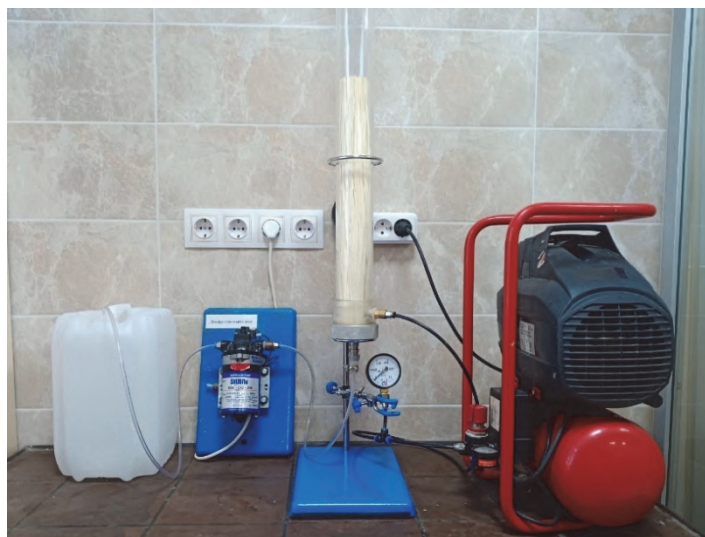
Рисунок 2 – Лабораторная установка для тонкой очистки воды при помощи погружных ультрафильтрационных элементов
