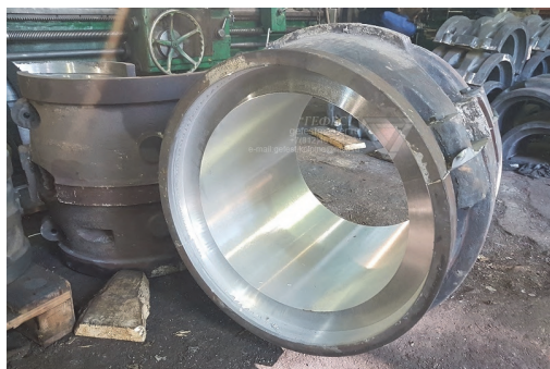
Рисунок 4 – Подшипник с баббитовым вкладышем марки Б88
