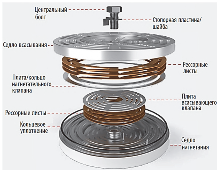
Рисунок 2 – Особенности конструкции концентрических клапанов
