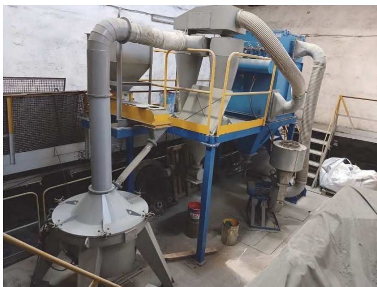
Рисунок 1 – Лабораторный образец центробежно-ударного оборудования в составе комплекса, по получению RDF-топлива
