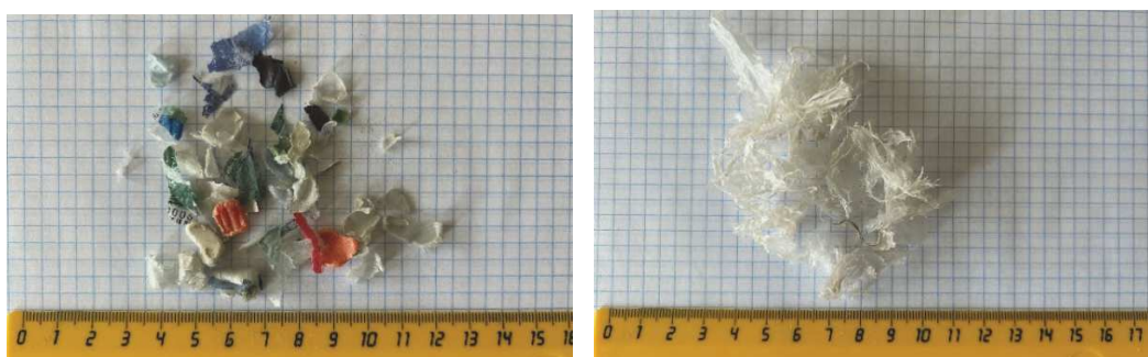
Рисунок 5 – Образцы измельченного полимерного материала на центробежно-ударной установке при 3000 об/мин, в зависимости от исходного сырья:
