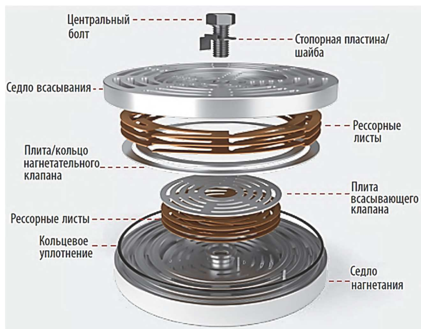
Рисунок 2 – Особенности конструкции концентрических клапанов
