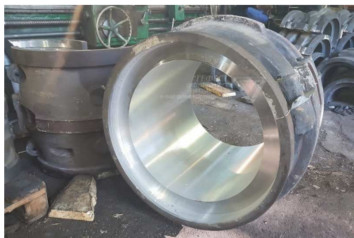
Рисунок 4 – Подшипник с баббитовым вкладышем марки Б88
