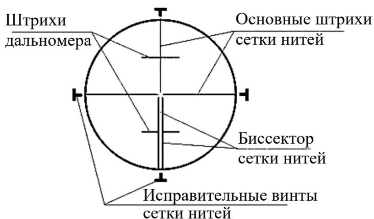
Рис. 3.2. Сетка нитей зрительной трубы теодолитов Т30 (2Т30)
