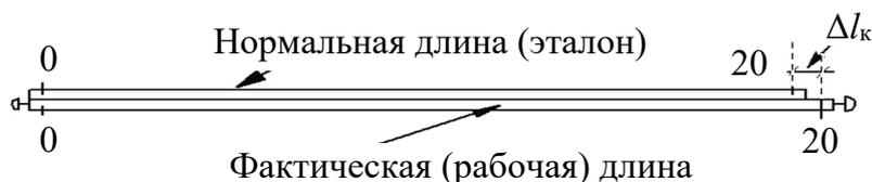
Рис. 3.27. Компарирование землемерных лент (рулеток)
