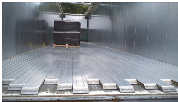
Рис. Л4.15. Подвижной пол в прицепах щеповозов
