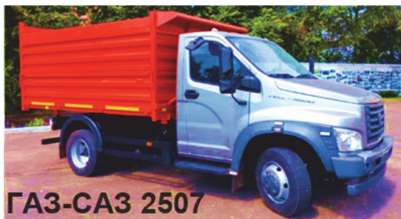
Рис. Л4.11. Грузовой автомобиль для вывозки щепы
