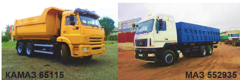
Рис. Л4.12. Большегрузные автомобили для вывозки щепы
