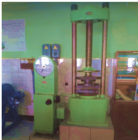
Рис. Л5.3. Гидравлический пресс ПСУ-50
