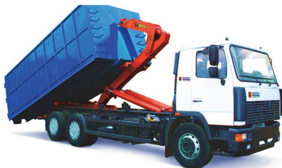
Рис. Л4.16. Автощеповоз с системой мультилифт
