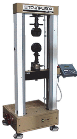
Рис. Л5.1. Разрывная машина ИР 5057-50
