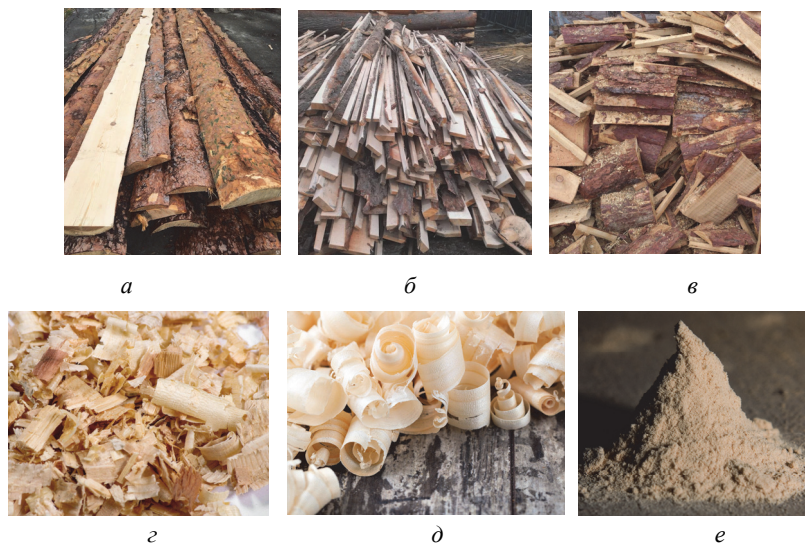
Рис. Л1.3. Отходы деревообрабатывающих производств: а – горбыль; б – рейки; в – срезки и отторцовки; г – опилки; д – стружка; е – древесная пыль
