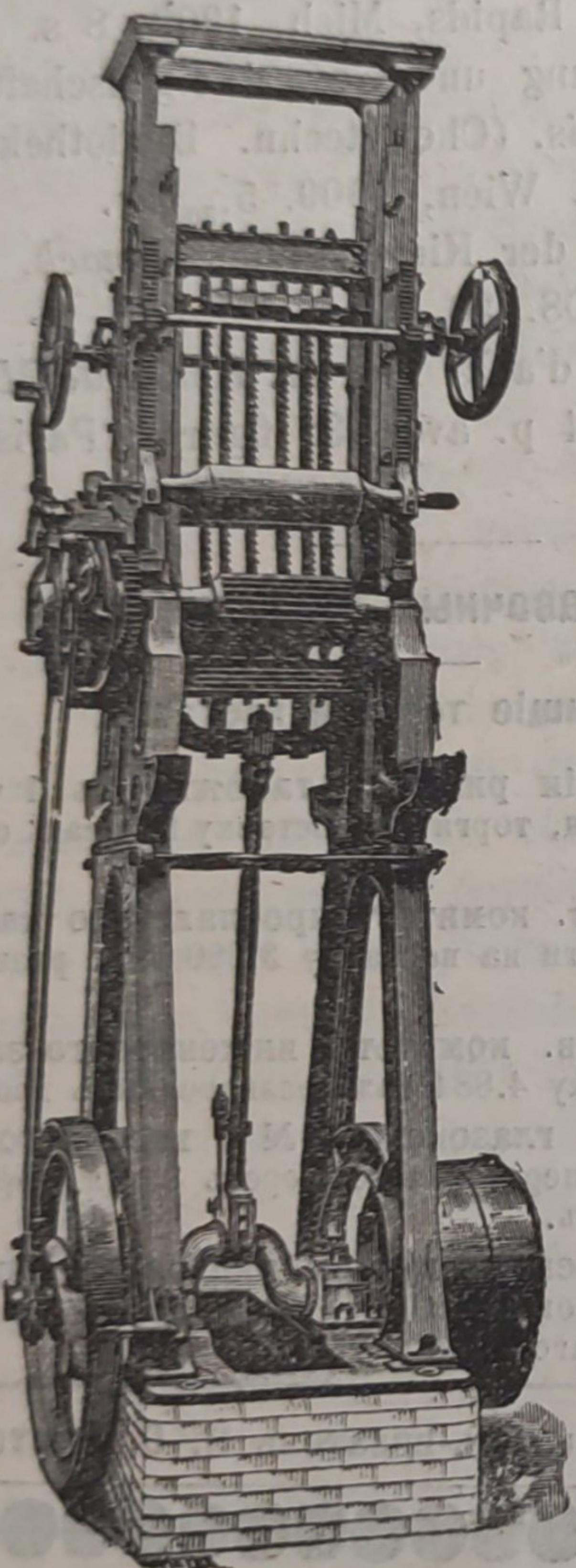
Строгальные станки новѣйшей конструкціи и недостигнотай еще по сie время производительности изготавливаются въ болѣе чѣмъ 30 величинъ. Съ нашимъ строгальнымъ станкомъ № 12 была достигнута производительность въ 100000 футъ или 43000 аршинъ гребня и паза въ теченіе 10 час.
