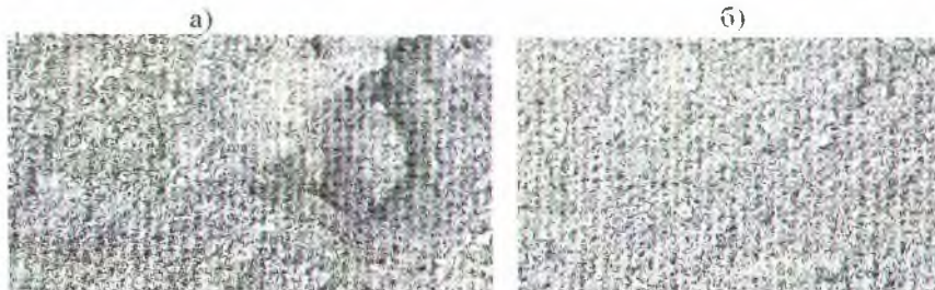
Рисунок 22 – Результат обработки алюминиевой суспензии в ССКА (увеличено в 100 раз): а) до обработки; б) после обработки
