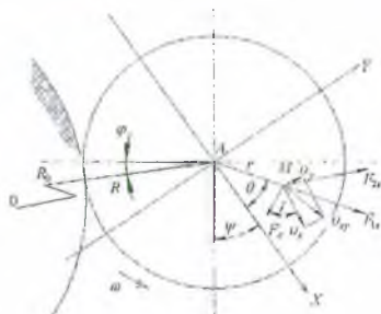
Рисунок 18 – Расчетная схема вертикальной планетарной мельницы
