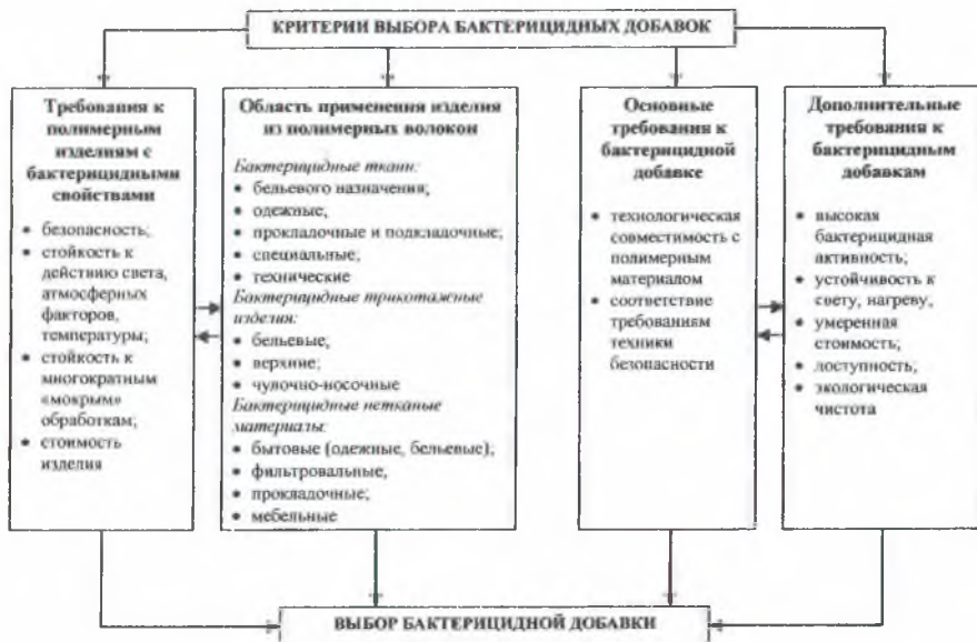
Рисунок 1 – Алгоритм выбора бактерицидных компонентов для модифицирования ПЭТФ волокон
