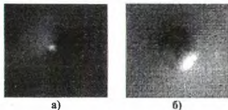
Рисунок 7 – Результаты испытаний методом падающего бойка покрытий на основе исходной эмали ЭП-1236 (а) и наполненной трепелом (0,5 мас.%), термообработанного при 1023 К (б).
