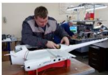
Настройка и установка бортового оборудования
