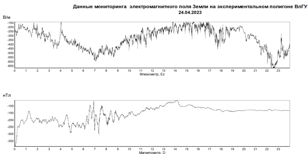
Рис.6 - Синхронные суточные записи геомагнитного поля (компонента D) и электрического поля ( E_z ) по результатам мониторинга станции ВлГУ. Магнитная буря класса G3 и G4 от вспышки до 15 часов.
