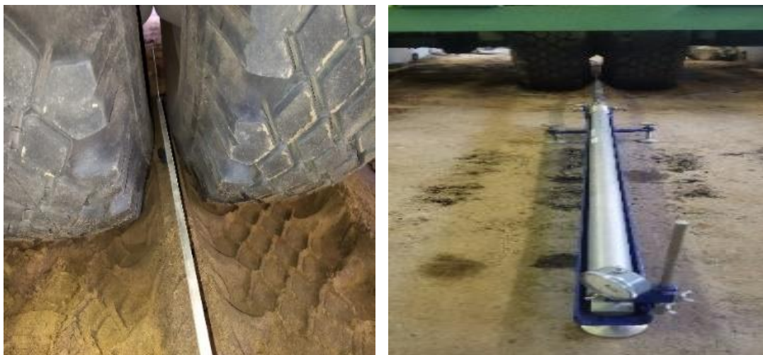
Рис. 6 - Процесс измерения модуля упругости
