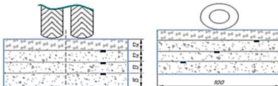
Рис. 3- Схема расположения месдоз
