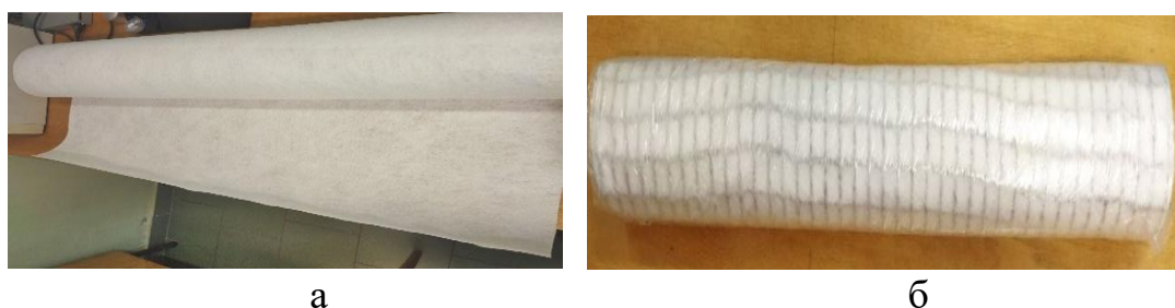
Рис. 2 - Геопрослойки: а) – геополотно «Тератекс» ТС 1500; б) – геокompозит Тератекс ТС-А-50
