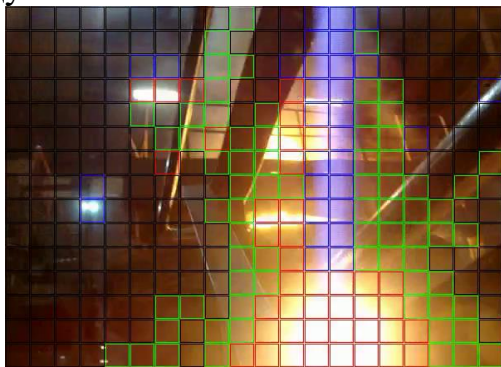
Рис. 1 - Нейросетевая сегментация видеокadra методом скользящего окна с индикацией цветом
