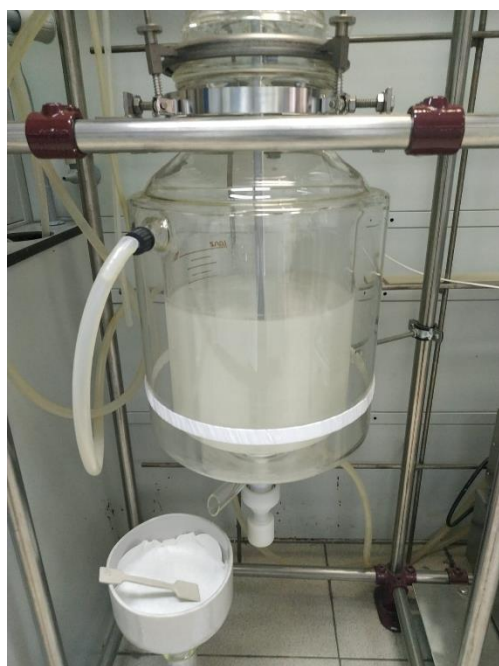
Рис. 2 - Реактор для масштабирования синтеза [2,2]-парацicloфана
