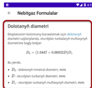
Формула расчёта диаметра Долота
