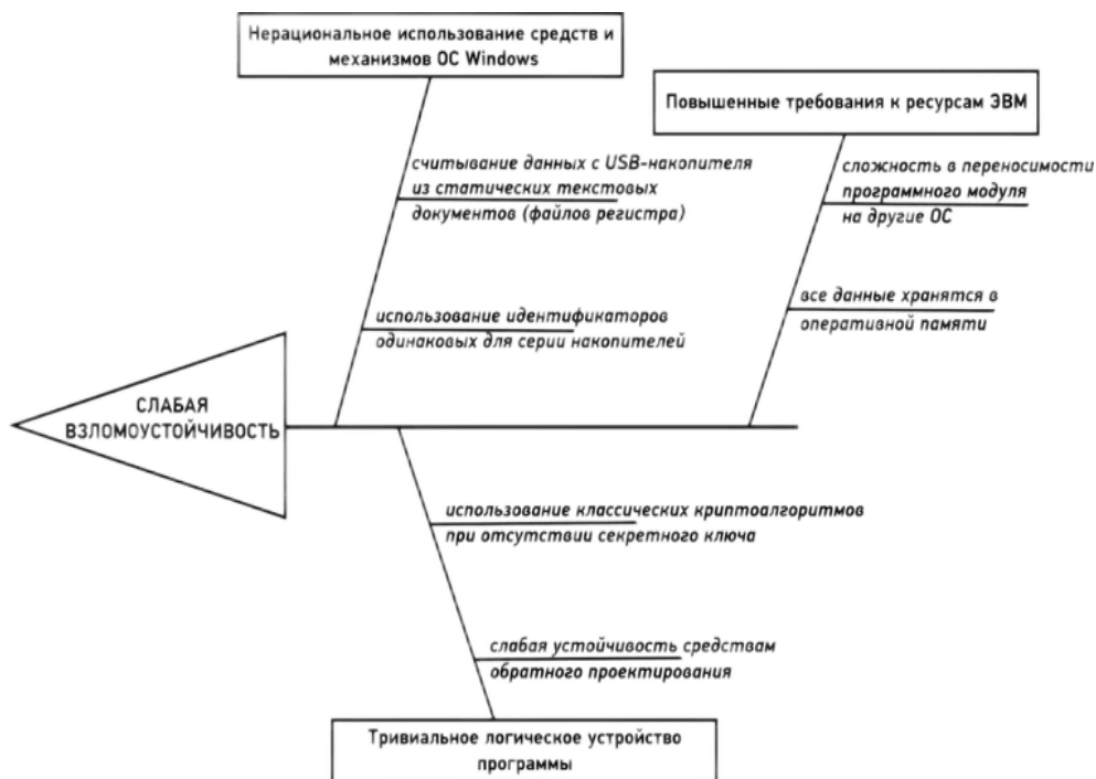
Рис. 1 - Диаграмма Исикавы анализа причин низкой взломостойчивости существующих средств защиты от несанкционированного копирования
