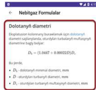
Формула расчёта диаметра Долота
