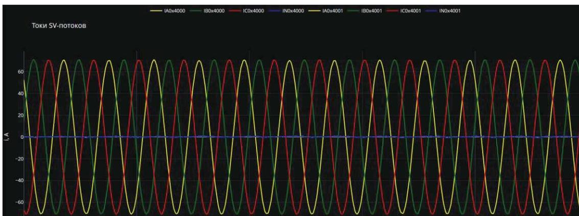
Рис. 1 – Пример отображения анализатором записанной осциллограммы
