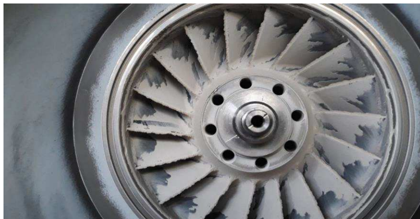
Рис. 1- Налет на поверхности лопаток турбокомпрессора в виде кристаллического соединения (цех карбамид-3 ОАО Гродно Азот – 2021 год).
