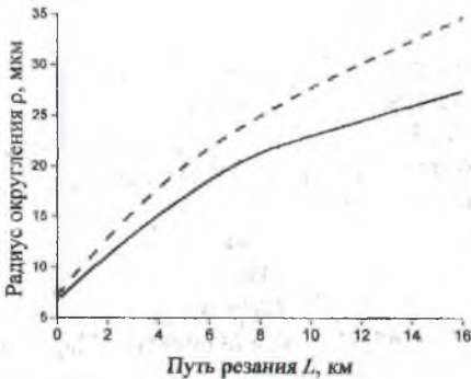
Рис. 1. Динамика затупления фрезерного ножа ВК6 (— механическое крепление; --- пайка) Рис. 2. Динамика затупления фрезерного ножа ВК15 (— механическое крепление; --- пайка)
