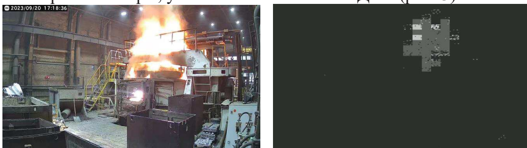
Рис. 3 - Сегментация огня на видеокадре с камеры наблюдения с применением сверточной нейронной сети U-Net: а) исходный видеокадр; б) результат сегментации видеокадра
