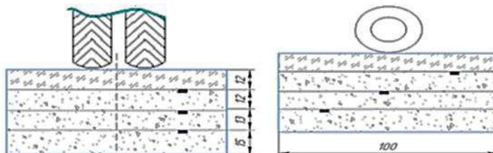
Рис. 3- Схема расположения месдоз
