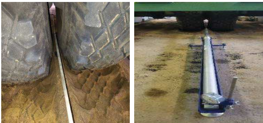
Рис. 6 - Процесс измерения модуля упругости
