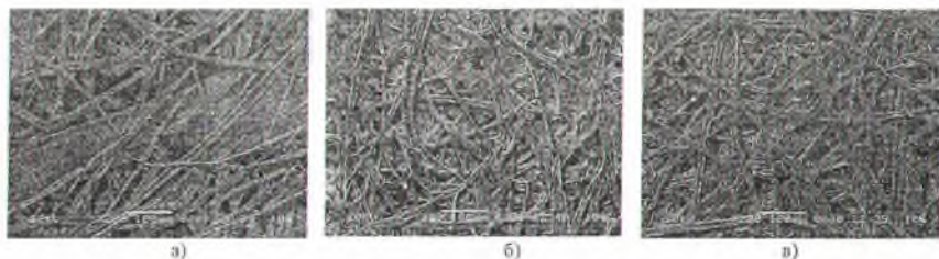
а – исходная масса, б – модифицированная карбамидом масса, в – модифицированная щелоком от магний-бисульфитной варки целлюлозы масса
