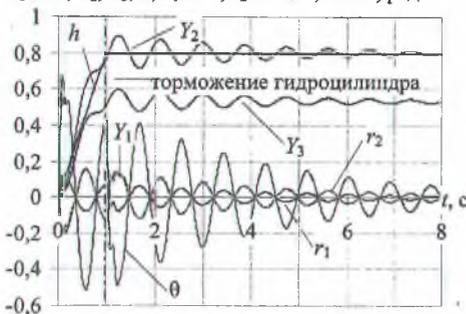
Рисунок 5 – Расчетные кривые перемещений элементов системы при подъеме хлыста за комель
