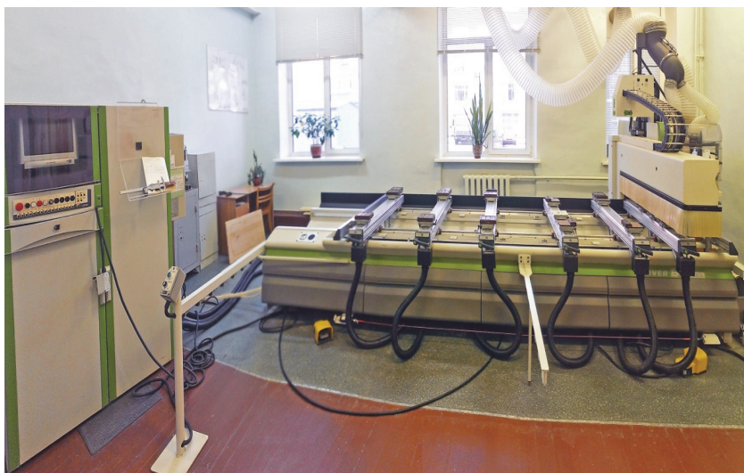
Рис. 2.1. Лабораторная установка на базе станка с ЧПУ Rover B 4.35
