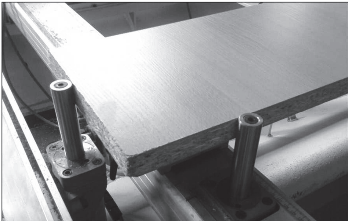
Рис. 2.13. Пример установки заготовки на станок перед выполнением программы
