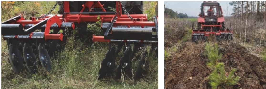
Рис. 13.5. Двухрядная дисковая борона ZKT-2500Л: а – общий вид; б – седлание ряда культур
