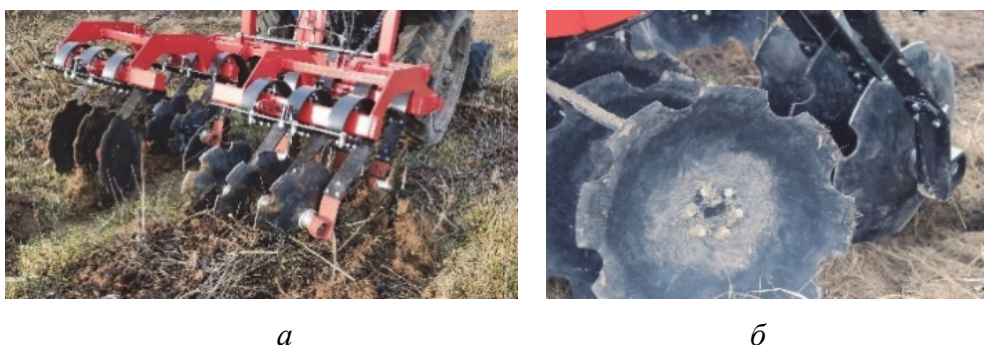
Рис. 13.3. Двухрядная дисковая борона ZKT-2500 Л-2: а – общий вид; б – дисковые секции
