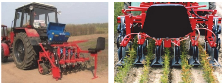
Рис. 7.4. Машина для внесения удобрений: а – на культиваторе ГС «Эгедаль»; б – на культиваторе ЗКТ-2000
