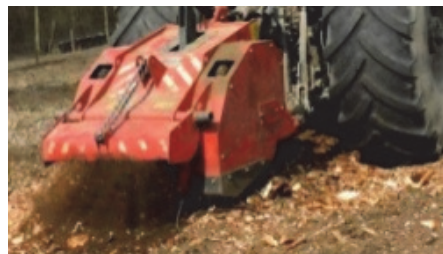
Рис. 11.6. Ротоваторы ZKT в работе: a – MJH-0.8, MJH-1.2; б – ZKT-700
