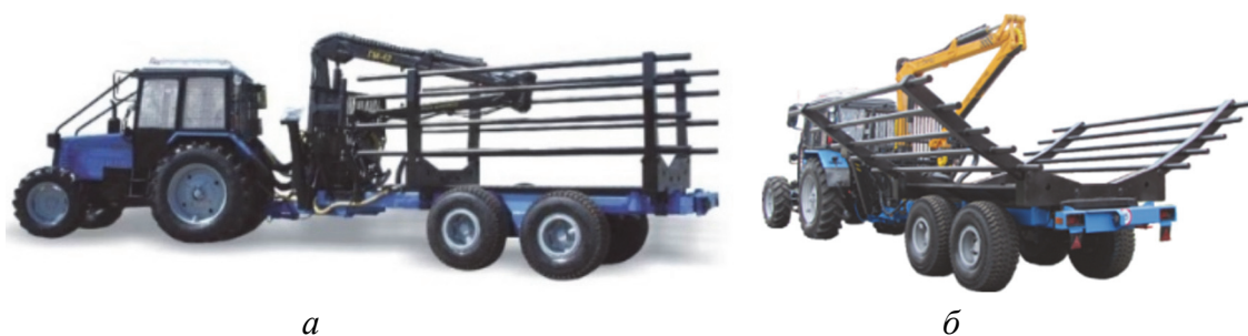
Рис. 10.3. Схема устройства подборщиков: а – ОПЛ; б – ОПЛ.М
