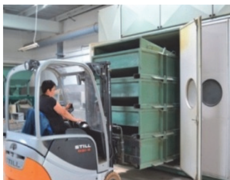
Рис. 3.7. Сушильный шкаф BW-1600 Nomeko: а – загрузка ящиков с шишками; б – шкаф в режиме сушки шишек
