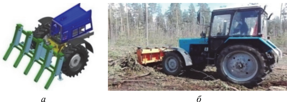
Рис. 10.2. Оборудование уборочное лесохозяйственное ОУЛ-24: а – схема устройства; б – процесс сгребания
