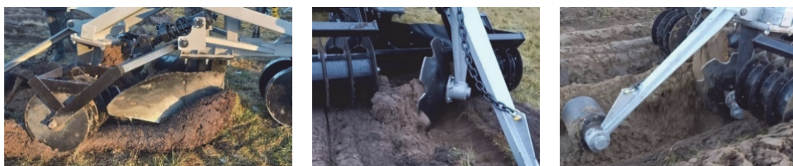
Рис. 11.4. Плуг лесной двухотвальный ЗКТ-2 POWER: а – вид сбоку; б – вид сзади; в – формирование микроповышения
