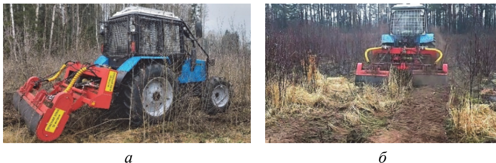
Рис. 13.7. Косилка-измельчитель роторная ZKT-250: а – общий вид; б – обработка культур
