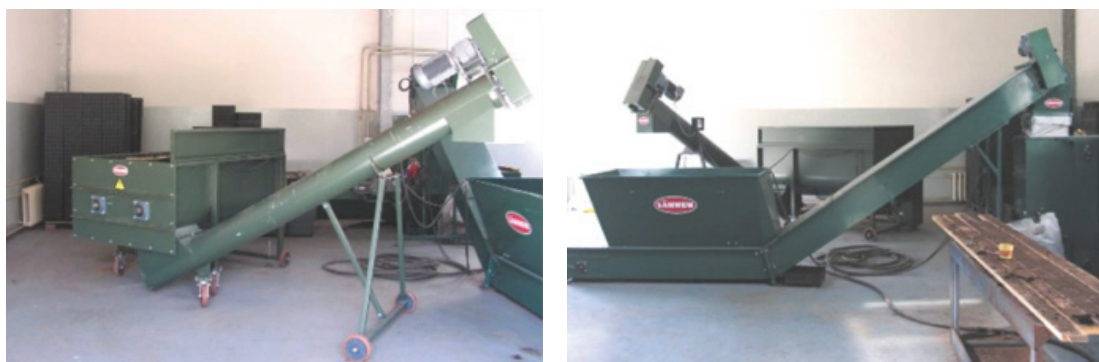
Рис. 6.2. Смеситель и винтовой транспортер ( а ) конвейера наполнителя ( б )
