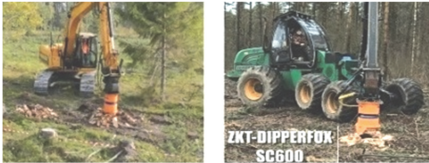
Рис. 10.7. Измельчители пней: а – ZKT серии «КРОТ»; б – ZKT-DIPPERFOX
