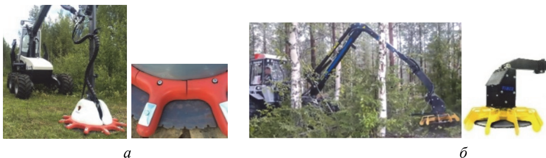
Рис. 13.8. Машина Usewood с валочной головкой UW180S (а) и Vimek 404 T6 с валочной головкой UW50 (б)
