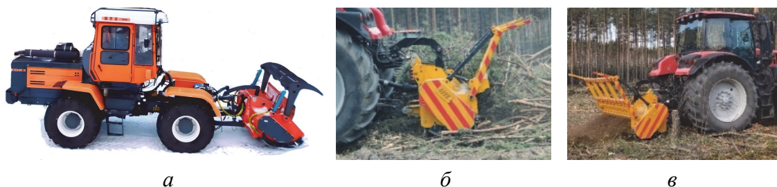
Рис. 10.5. Мульчер ZKT-2300 MERICRUSHER: а – общий вид; б – измельчение порубочных остатков; в – мульчирование почвы
