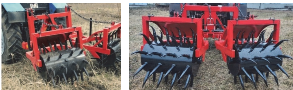
Рис. 13.4. Борона лесная кольчатая ZKT-2500K («вал Кроковского»): а – общий вид; б – кольчатые секции
