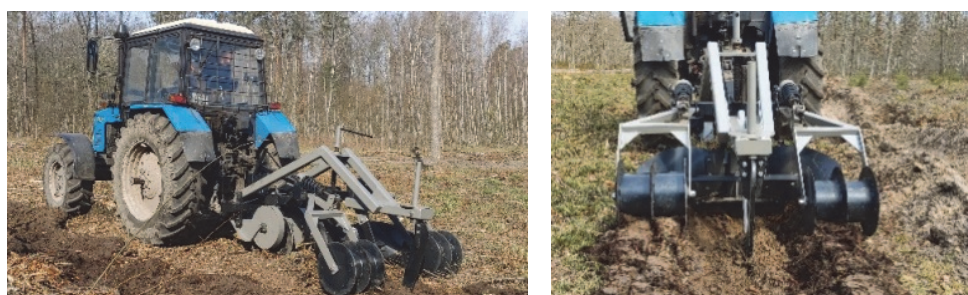
Рис. 11.3. Плуг лесной двухотвальный ЗКТ-2: а – вид сбоку; б – вид сзади
