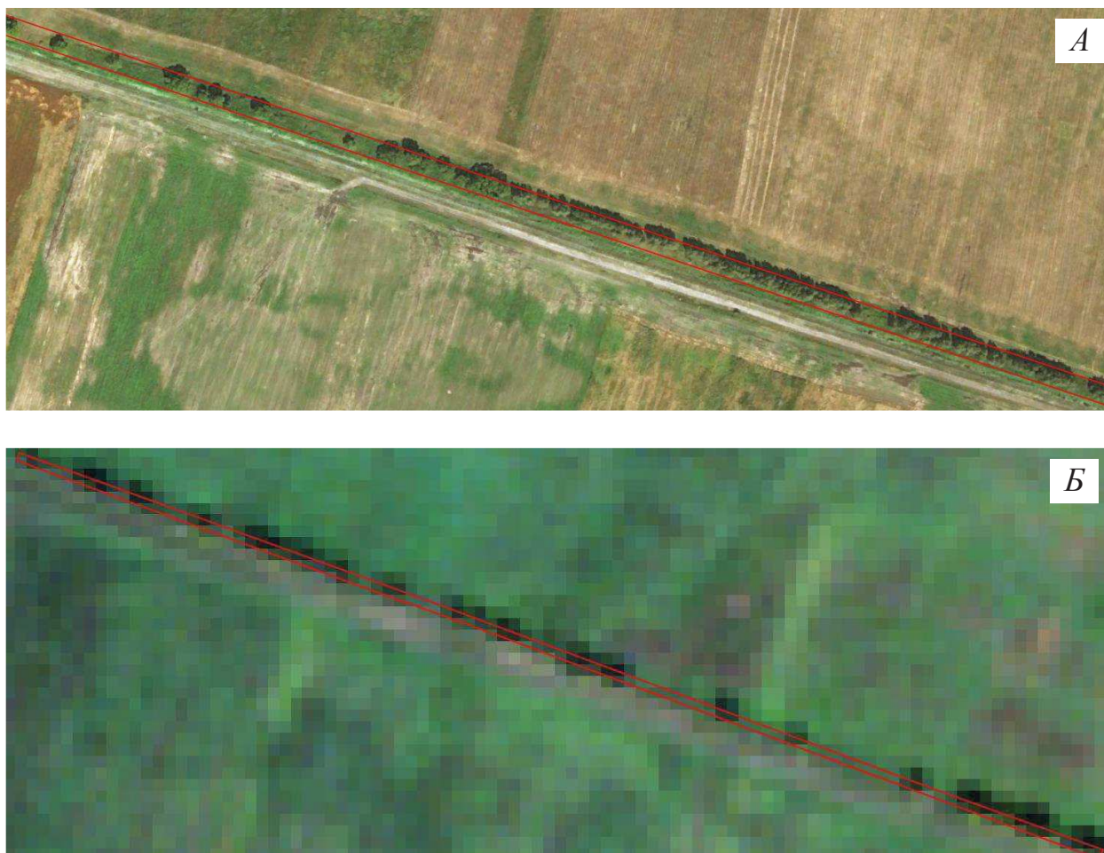
Рисунок 1 – Отображение полосы ЗДН на снимках ДДЗЗ разного пространственного разрешения: а) материалы сверхвысокого пространственного разрешения геосервиса BingAreal (0,5 м); б) – материалы космической съемки Sentinel–2 (10 м)
