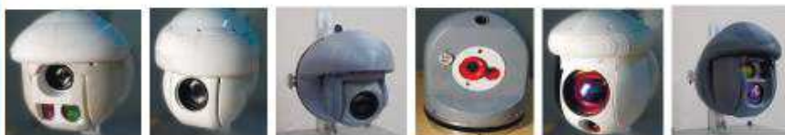
Гиростабилизированные оптико-электронные системы (фото, ТВ,- ИК-камеры)
