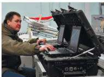
Наземный пункт управления с системой передачи данных
