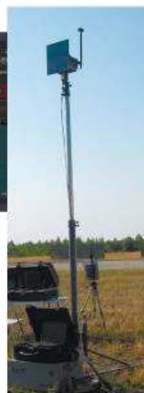
Наземный пункт управления с системой передачи данных
