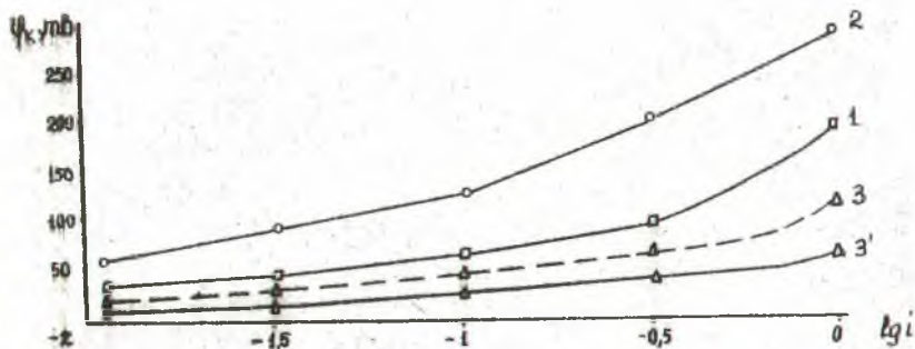
Рис. 3. Катодные поляризационные кривые для МЭБ, сформированных различными методами. Обозначения аналогичны рис. 2. Количество нанесенного катализатора 2 \text{ мг/см}^2 . 3' - катализатор нанесен методом термодатного прессования, 4 \text{ мг/см}^2 .
