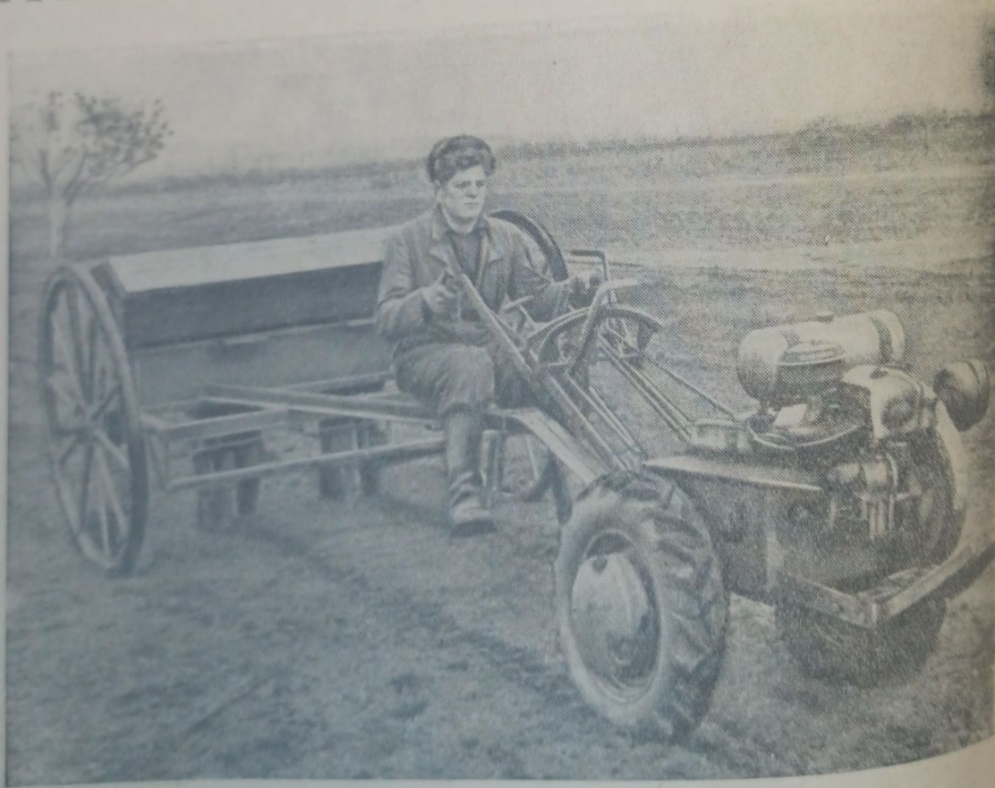
Лесная сеялка конструкции А. Н. Золотова с трактором С0Т (Павловский гослесопитомник, Воронежской области).
