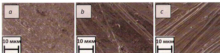
Рис. 1. СЭМ-изображения поверхности молибденовой фольги: a – до проведения подготовительных технологических операций, b – после шлифования поверхности, c – после обезжиривания
