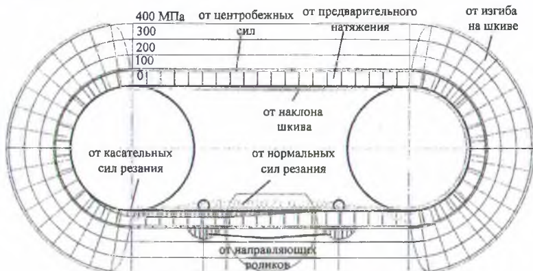
Рисунок 2 – Эпюры напряжений для точки, находящейся во впадине зуба с наружной стороны пилы
