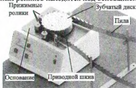
Рисунок 5 – Установка для проведения упругопластического деформирования ленточной пилы
