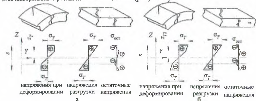
Рисунок 4 – Напряжения, возникающие в полотне ленточной пилы при упругопластическом деформировании
