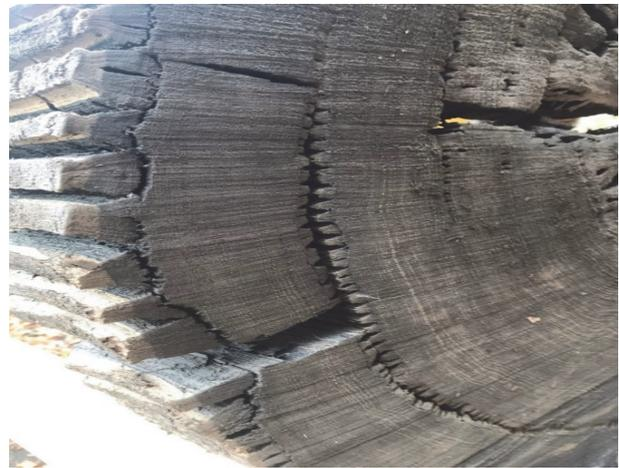
Рис. 4. Последствия неправильного режима сушки
