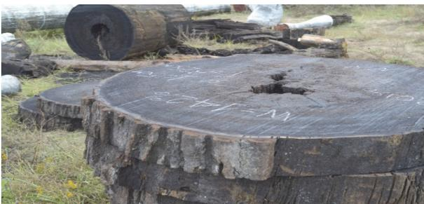
Рис. 3. Срез влажностью 142% с целым периферийным слоем
