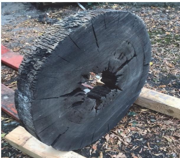
Рис. 5. Деформации спила мореного дуба
