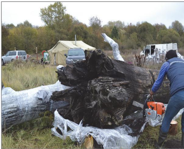
Рис. 2. Процесс раскряжевки мореного дуба
