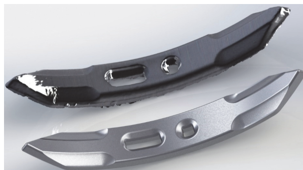
Рис. 6. Лапка сошника до и после реверс-инжиниринга
