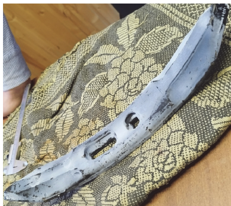
Рис. 2. Лапка сошника Amazone перед сканированием
