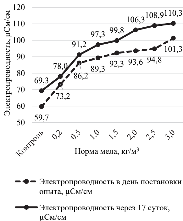
Рис. 2. Динамика изменения электропроводности торфа фрезерной заготовки при внесении мела
