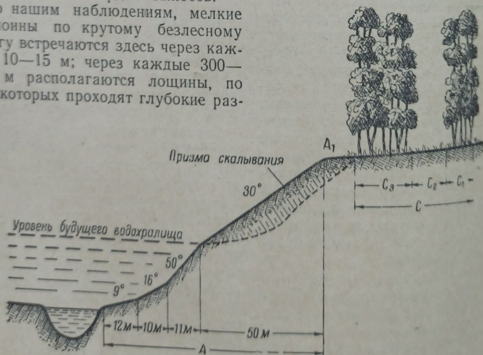
Рис. 6. Схема скалывания крутого корзиночного берега и размещения прибрежных полос.
