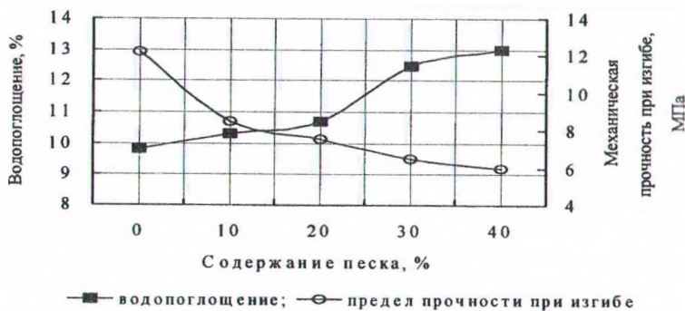
Рисунок 4 – Влияние содержания кварцевого песка на величину водопоглощения и механическую прочность при изгибе опытных образцов (Тобж=1000°C)
