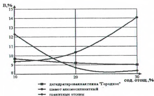
Рисунок 1 – Зависимость водопоглощения образцов на основе глины месторождения "Городное" от вида и количества отощителя при температуре обжига 1150 °С
