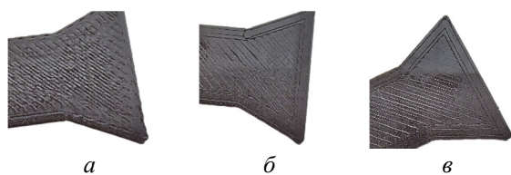
Рис. 2. Короткие образцы из ABS: а – с юбкой; б – полем; в – плотом
