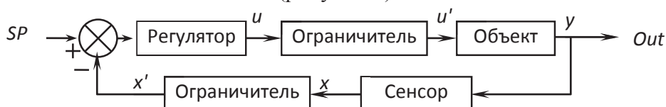
Рисунок 1 - Общая структура регулирования обратной связью
