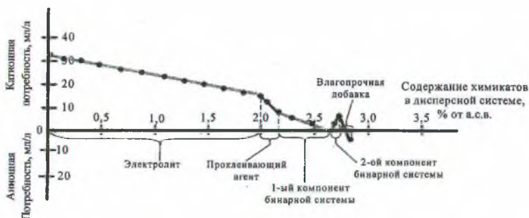
Рисунок 7 – Принцип целенаправленного изменения ионной потребности дисперсионной среды путем введения в волокнистую суспензию химикатов
