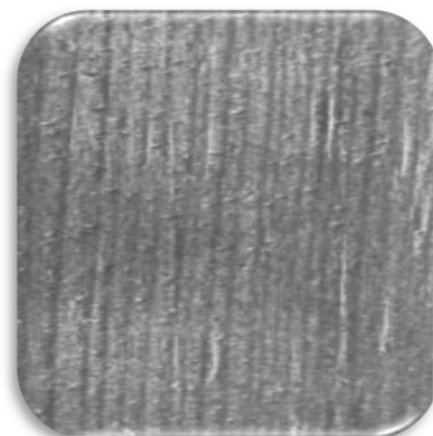
Рисунок 5. Поверхность сырого шпона с видом дефектов – ворсистости и ряби
