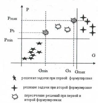
Рисунок. Решение задачи оптимального резервирования: G — вес устройства; P — уровень надежности;  $G_{\max}$  — максимально допустимый вес устройства;  $P_{\min}$  — минимально возможный уровень надежности устройства
