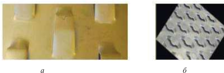
Рис.1. Фрагменты тарелок со стационарными клапанами АО ПО «Стронг»: а – с трапециевидными клапанами; б – с овальными клапанами
