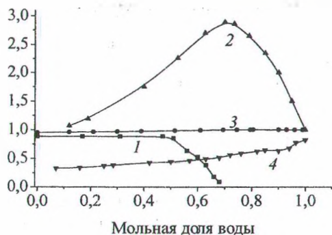
Рис. 4. Зависимости оптической плотности растворов (D) Pd-ОЭП ( \lambda_{\text{рег}} = 546 \text{ нм} , C = 3,5 \cdot 10^{-5} \text{ моль/л} ) и некоторых макроскопических характеристик смесей ДМФ с водой ( \eta , \rho , \epsilon ) от мольной доли воды: 1 — D; 2 — \eta ; 3 — \rho ; 4 — \epsilon
