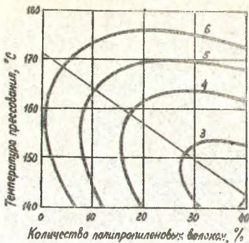
Рис. 1. Кривые влияния количества полипропиленовых волокон и температуры прессования на разрывной груз/в кгс/ бумаги при количестве полиэтиленовых волокон 20%, давлении 11 кгс/см 2 и времени прессования 2 мин.
