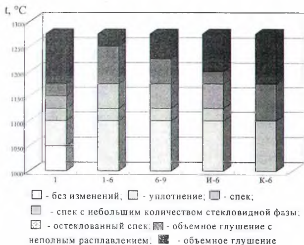
Рисунок 4 – Сравнительная характеристика процессов глазуобразования в исследуемых сырьевых композициях
