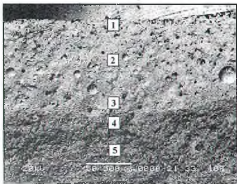
Рисунок 6 – Электронно-микроскопическое изображение контактной зоны «глазурь – керамика» для состава К-6
