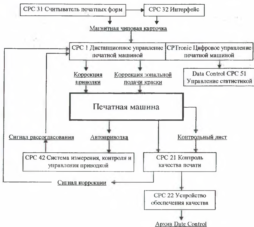
Рис. 1. Функциональная схема системы управления и автоматизации печатным процессом
