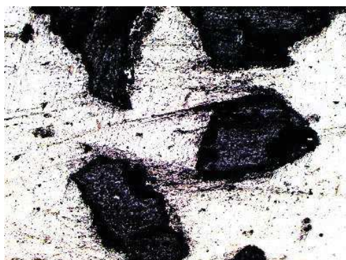
Рисунок 2 – Микроструктура алмазосодержащего композита на основе спеченного твердого сплава ВК-8 (x200)
