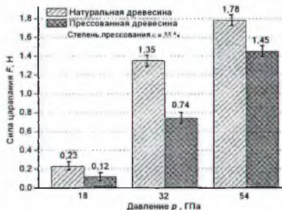
Рисунок 8 – Диаграмма изменения силы царапания при увеличении давления для натуральной и прессованной древесины
