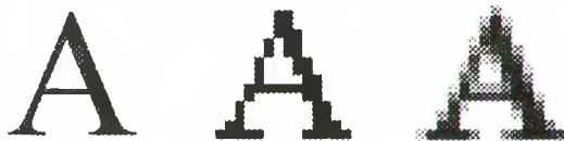
Рисунок. Контуры символа в печатном издании, на экране монитора без сглаживания, на экране монитора со сглаживанием
