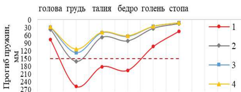
Рисунок 2 – Влияние диаметра проволоки пружины D = 60 мм на прогиб пружинного блока
